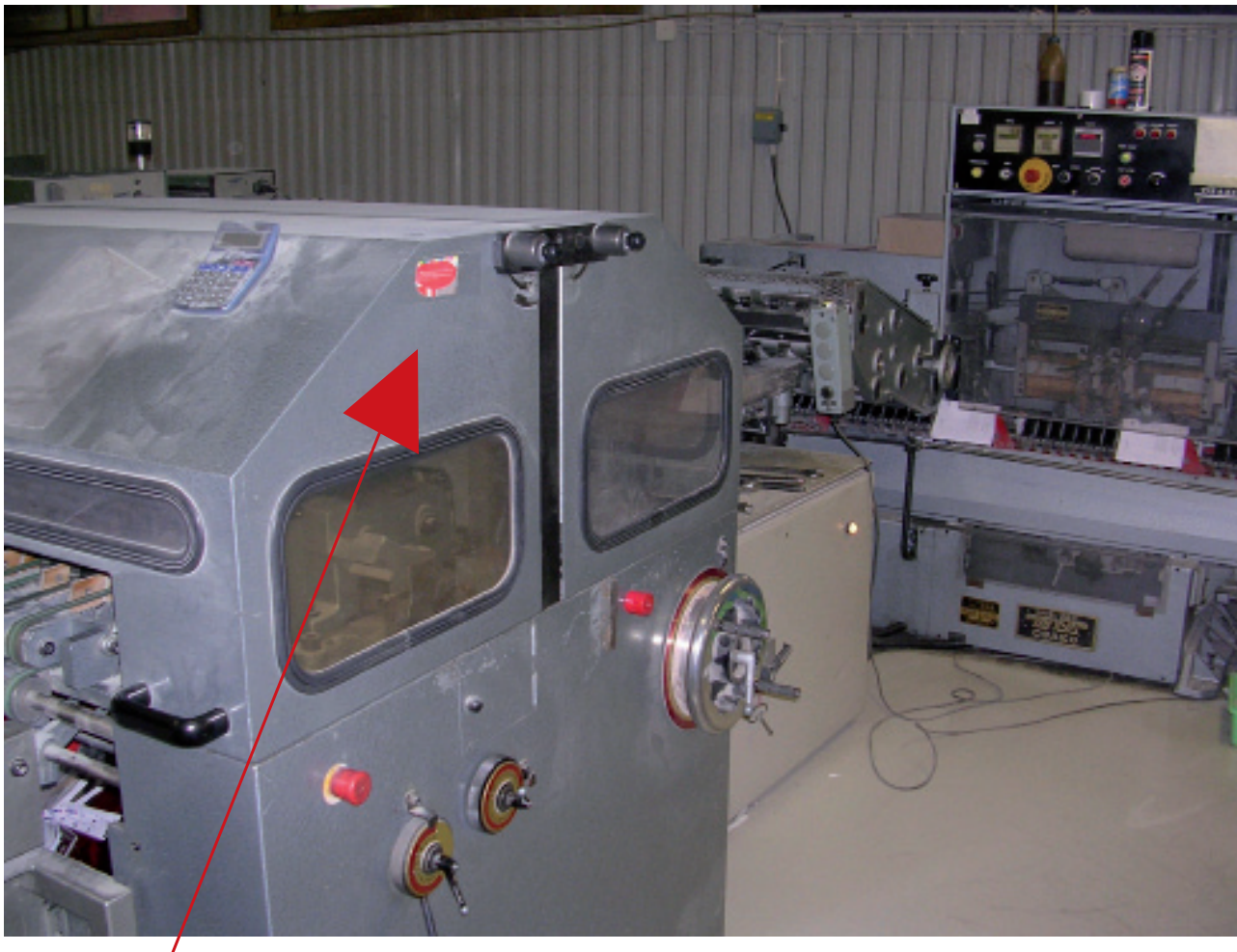
Förreglande avskärningskydd på en treknivsmaskin.
